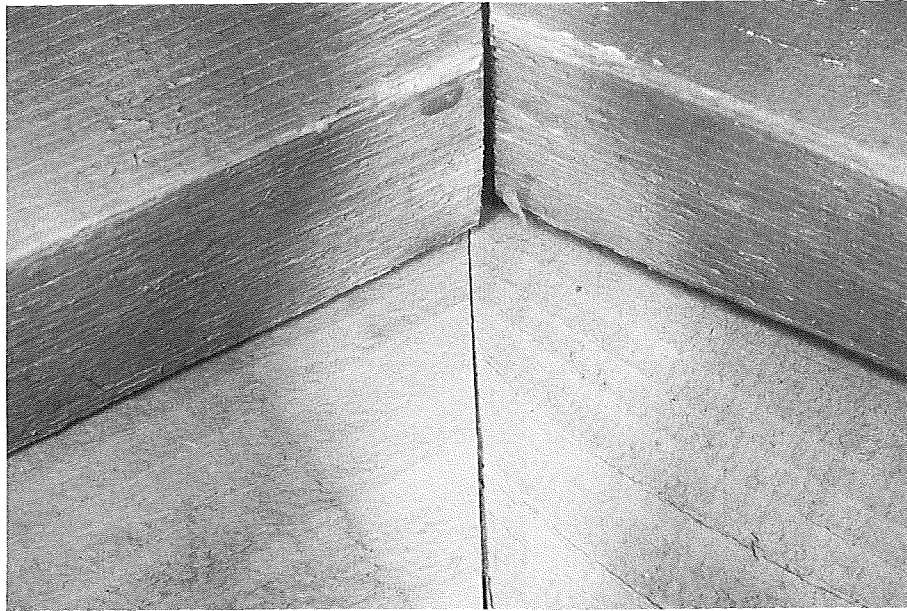
Figur 48. Den ny klima- simulator: Samling i stern- bræt efter 2½ måneds ældning.
