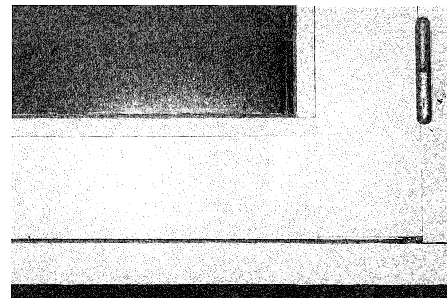
Figur 58. Den ny klima-simulator: Hjørnesamling af vindue efter knap 7 måneders ældning.
