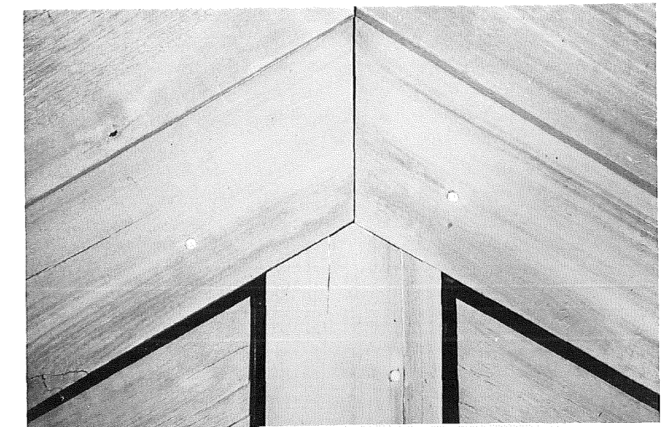
Figur 47. Den ny klima-simulator: Spidsafslutning af bræddebeklædning efter knap 7 måneders ældning.
