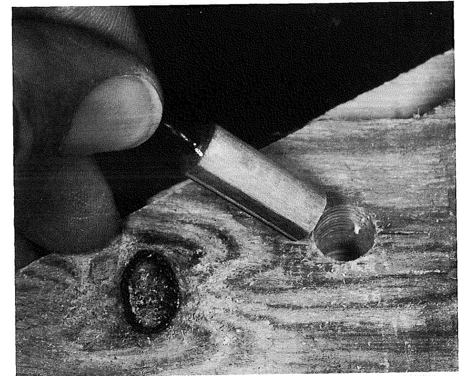
Figur 9. Prøveemne: Indboring af fugtmåledyvel.
