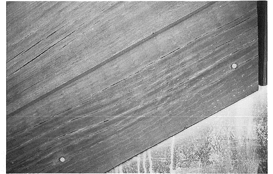
Figur 53. Den ny klima- simulator: Midtersamling efter knap 7 måneders ældning.
