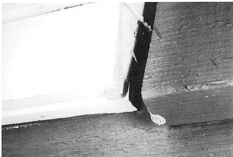
Figur 60. Den ny klima-simulator: Hjørnesamling af vindue efter knap 7 måneders ældning.
