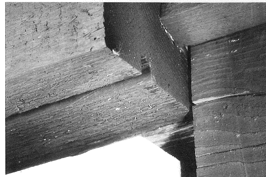
Figur 63. Den ny klima-simulator: Vandnæse over vindue efter 2½ måneders ældning.
