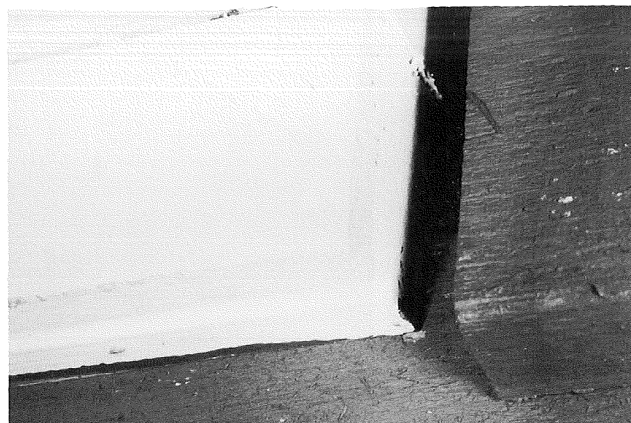
Figur 55. Den ny klima-simulator: Hjørnesamling af vindue efter 1 måneds ældning.
