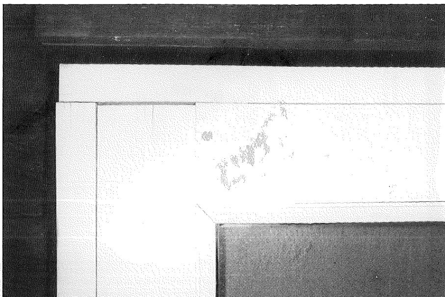
Figur 62. Den ny klima-simulator: Hjørnesamling af vindue efter knap 7 måneders ældning.
